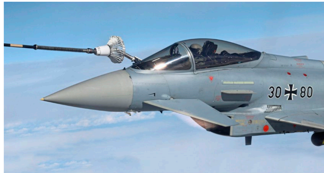
Eurofighter des TaktLwG 74 waren die ersten Spritempfänger. Kontrolliert wird das Tanksystem von der Bedienerstation hinter dem Cockpit.
